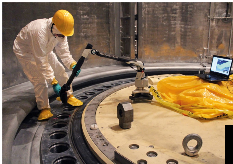
Měření hlavní dělicí roviny reaktoru JE Temelín za účelem monitorování velikosti otlaků od těsnění
