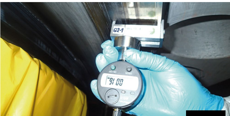
Obr. 3: Fotografie z měření otlaků ve víku R.
