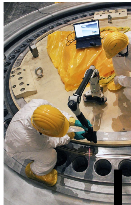
Obr. 5: Fotografie z 3D měření HDR a víka reaktoru JE
