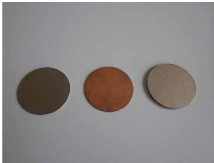
▲ Vzorky potenciálních materiálů UOS - zleva uhlíková ocel, měď, titanová slitina
