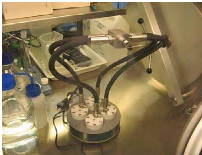
▲ Korozní cely umístěné v anaerobním boxu
