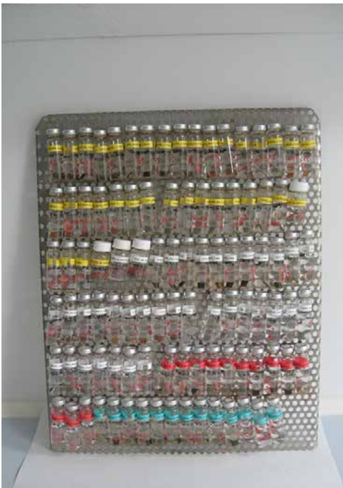
▲ Sestava vzorků před umístěním do ozařovny
