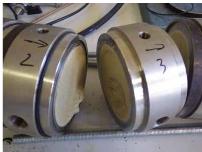
▲ Sycení bentonitu v experimentální cele
