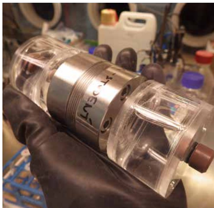
▲ Difúzní cela se vzorky bentonitu a korozních produktů umístěná v anaerobním boxu
